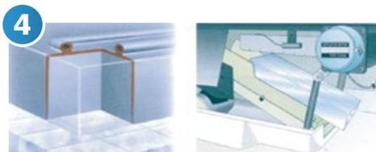
Le glaçon va tomber de l'évaporateur dans le compartiment à glaçons. La plaque à eau sera rincée à l'eau claire pour éliminer toutes particules résiduelles avant de commencer à se refermer. L'eau claire continue à entrer jusqu'à ce que le réservoir soit plein pour permettre de commencer un nouveau cycle de production.
