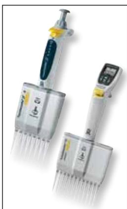
Pipettes à coussin d'air, multicanaux
