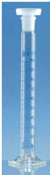
Les éprouvettes bouchées peuvent être utilisées comme les fioles jaugées pour réaliser des solutions standard et des dilutions.
