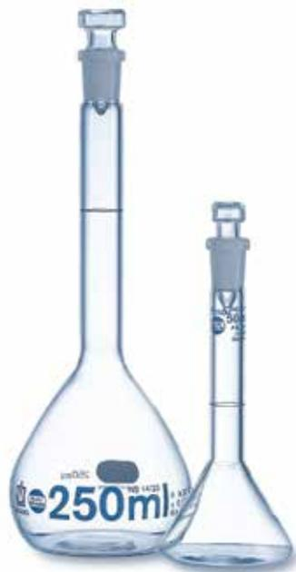
Les fioles jaugées, classe A et B, sont des appareils de volumétrie calibrés pour contenir 'In', qui servent en particulier pour préparer des solutions exactes, comme par ex. solutions étalons et standards, et dissolutions.
