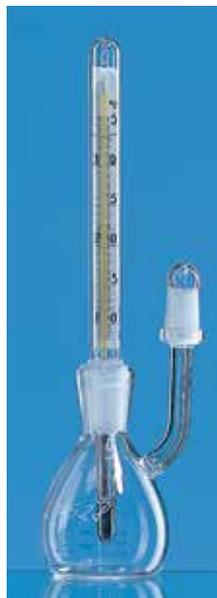
Pycnomètre avec thermomètre et capillaire latéral (recommandé pour les liquides avec une pression de vapeur élevée)
