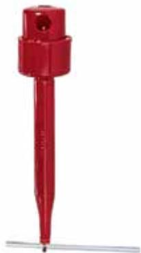
Porte pipette avec capillaire end-to-end
