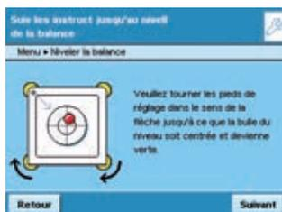
Q-Level propose la mise à niveau automatique motorisée sur pression de touche. Cubis® contrôle ainsi en permanence si la balance est parfaitement mise à niveau et signale immédiatement à l'utilisateur si une correction est nécessaire (seulement pour les modèles  $\leq 6,2$  kg et avec une précision de lecture  $> 0,001$  mg).
