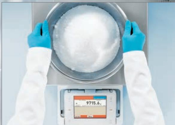
Le plateau de pesée de 300 × 400 mm est suffisamment grand pour que même de grands récipients soient parfaitement stables. Les surfaces de grande qualité et les unités de commande faciles à enlever permettent un nettoyage rapide et minutieux.
